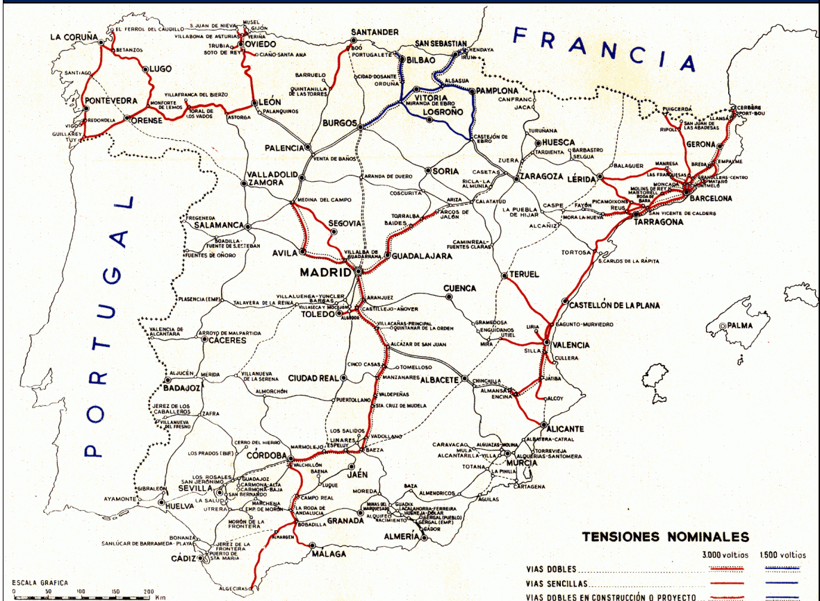
Mapa de las tensiones previstas de la Electrificación de Ferrocarriles de 1946. (Ministerio de Obras Públicas. 1946) 119
